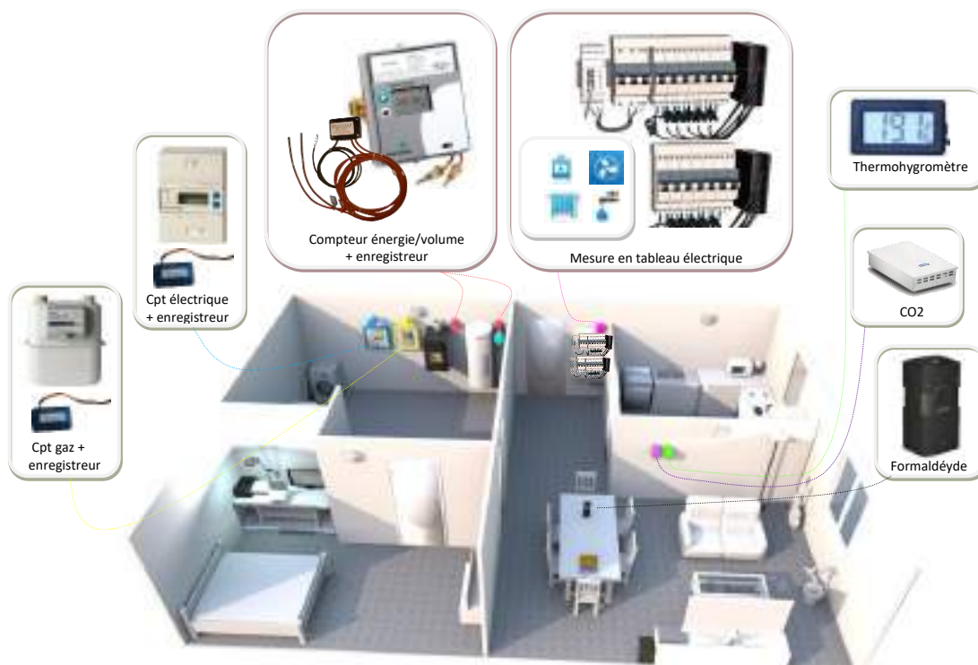
Figure 1 : Schéma de l'instrumentation des maisons en suivi « avancé ».
