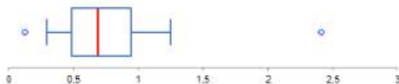
Figure 87 : Déciles, Quartiles, Médiane de la résistance des toitures en maisons individuelles après travaux. Source : « Etude sur la rénovation basse consommation des maisons individuelles » d'Avril 2021.
