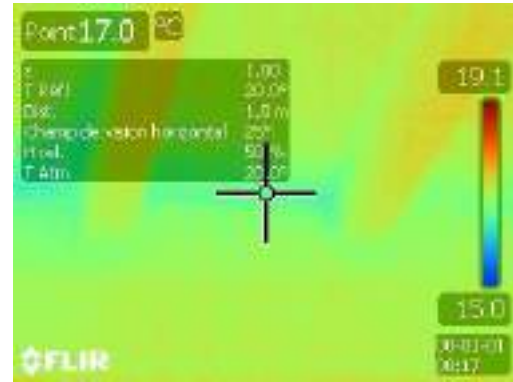
Figure 80 : Thermogramme intérieur de mur isolé par l'intérieur, au niveau du plancher intermédiaire bois.
