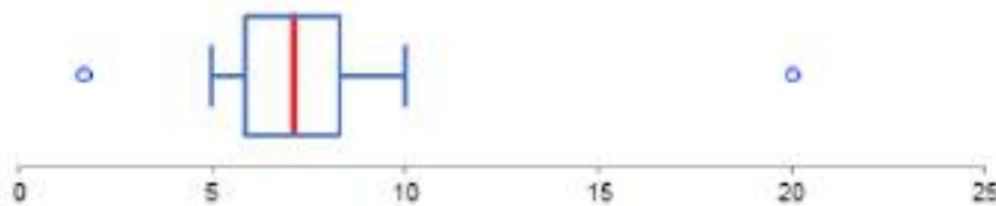
Figure 56 : Déciles, Quartiles, Médiane de la résistance des toitures en maisons individuelles après travaux. Source : « Etude sur la rénovation basse consommation des maisons individuelles » d'Avril 2021.
