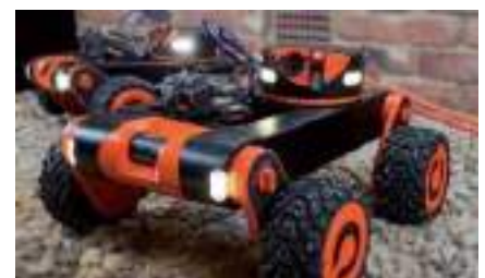
Figure 162 ci-contre : Illustration d'un robot permettant projeter du polyuréthane en sous-face d'un vide sanitaire de faible hauteur. Source : www.syneris-isolation.fr
