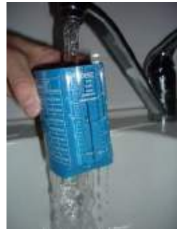
Figure 168 ci-contre : Illustration de la mesure de débit aux points de puisage ECS avec un débitmètre (source Enertech, image d'archive).
