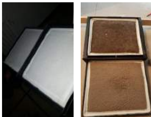
Figure 30 : Photo de filtres VMC double flux, propres (à gauche) et encrassés (à droite).
